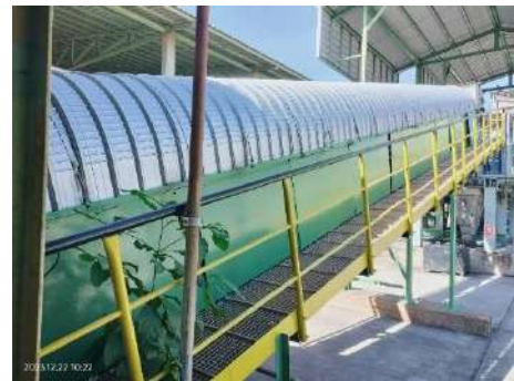
ภาพที่ 2.2-10 อุปกรณ์ปิดครอบสายพานลำเลียง อย่างมิดชิด
